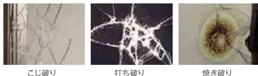
ガラス破りの代表的3つの手口を再現した実験結果
